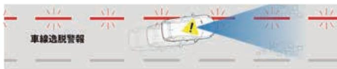
一定以上の速度で走行していて、**車線を越えてしまった場合に警告音で注意を促します**。車両のふらつきや居眠り運転などの危険な運転を防ぎ、安全な運転を促します。
